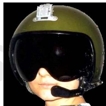
Directement issu des casques de vision nocturne infrarouge utilisés par les militaires, le système est capable de détecter des variations de température de la masse d'air d'environ 0,5°C. La visière intégrée au casque matérialise les « pompes » par différentes couleurs (rouge-orangé pour les zones les plus chaudes).
