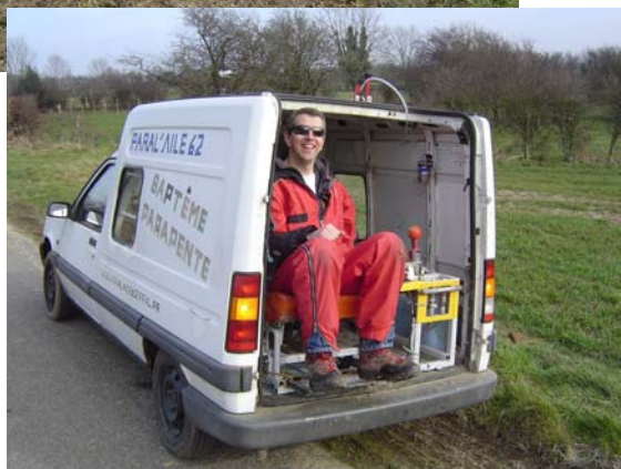
Géry aux manettes. Le nouveau moteur permet un rembobinage complet du câble en 30 secondes
